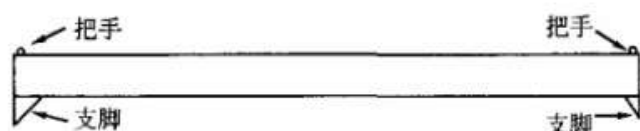
图 T 0973-2 路面横断面尺
